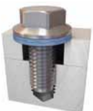
Avec des trous oblongs ou un matériau sensible au fluage, utilisez une vis ou un écrou à embase associé à une rondelle NORD-LOCK large (sp).
