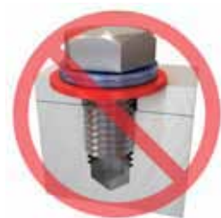
Ne jamais intercaler de rondelles plates sous les rondelles NORD-LOCK
