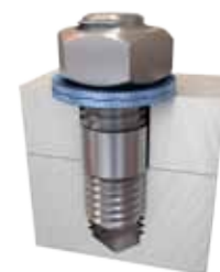
Avec des goujons, les rondelles NORD-LOCK sécurisent l'écrou, ce qui évite l'utilisation de colle.
